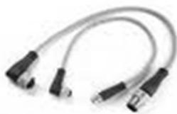
Connettori e prolunghe M8 e M12, diritti o a 90°, con e senza led. Tutti i connettori sono costampati su cavo 3,4 o 5 poli con lunghezze a richiesta. Corpo del connettore in materiale plastico PUR con ghiera in metallo e cavo in PVC o PUR ad alta movimentazione con omologazione UL/CSA. Colore standard grigio RAL 7001 e 7035. A richiesta colori arancio e nero.
