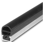
*Il bordo di sicurezza è composto da un profilo sensibile connesso ad una unità di comando. Con una leggera pressione sul profilo si provoca l'arresto del movimento. L'installazione dei profili su guida a C è estremamente semplice e versatile. Sono disponibili profili di diverse forme e materiale a seconda del tipo di condizioni d'urto e d'impiego.*
