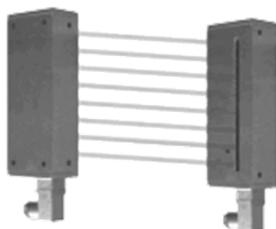
*Il sistema di misura con uscita analogica si compone di un trasmettitore e di un ricevitore in custodie separate alimentate a 24VDC. Il sistema genera una griglia di raggi paralleli con altezze a partire da 80mm. L'interruzione progressiva dei raggi fornisce un valore in tensione o in corrente proporzionale al numero di raggi interrotti. Il sistema viene fornito con uscite a cavo a conn. M12*
