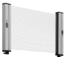
*Barriere di sicurezza tipo 2 e tipo 4 con altezze controllate da 150mm a 1650mm. Risoluzioni antidito, antimano e corpo da 2 a 84 raggi. Versioni con funzioni blanking fisso o flottante, muting esterno e versioni master/slave in cascata. Distanze operative fino a 50mt. Custodia ultracomatta dim. 28x41mm.*
